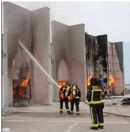
Figura 4: SATE con capa interior de aislamiento consumida.
